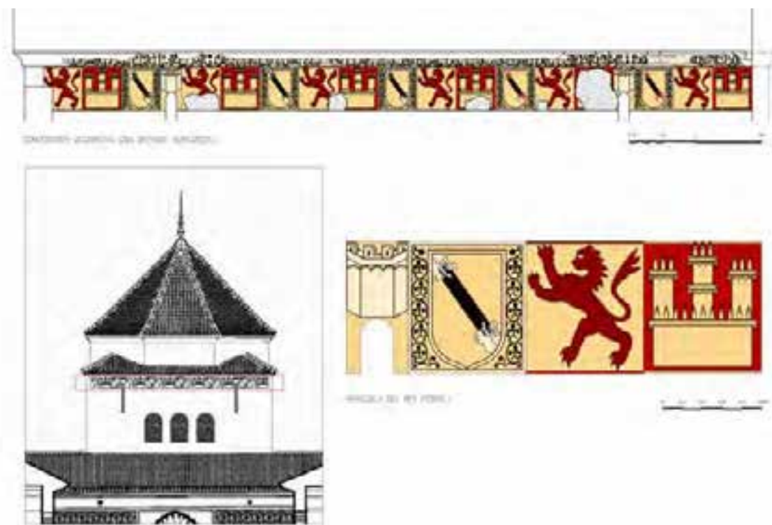
Figura 24. Detalle de la banda heráldica. Obsérvese su ubicación original, actualmente enmascarada por el forjado de la segunda planta, ocupando la zona superior de los cuatro frentes que conforma la qubba del palacio.
